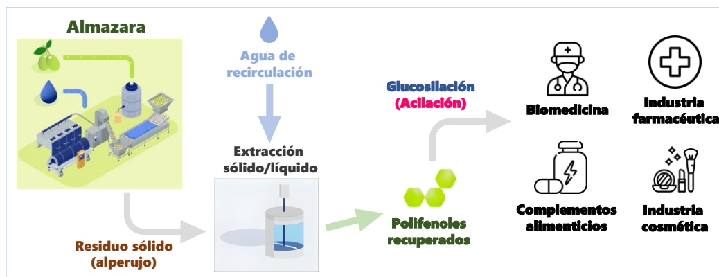
Figura 1. Esquema de obtención de polifenoles de la industria del aceite de oliva (proyecto LIFE CYCLOPS) y su posterior modificación enzimática para mejorar su aplicabilidad industrial.
